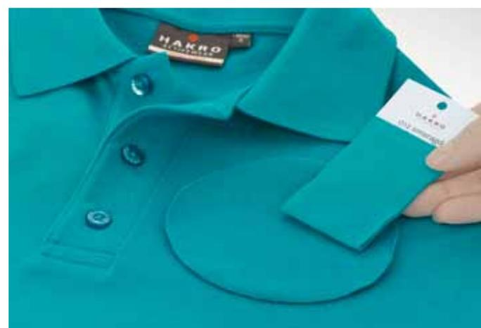
Die Farbkontrolle erfolgt zunächst technisch mit einem elektronischen Farbspektrometer. Anschließend findet durch unser QS-Team ein visueller Farbabgleich in unserer Lichtkabine unter verschiedenen, genormten Lichtarten statt.
