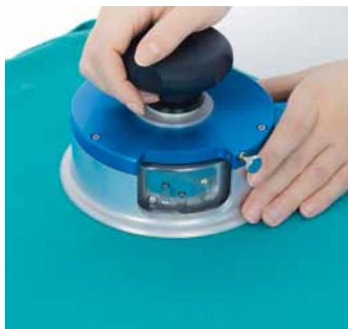
Mit einem speziellen Probenschneider wird aus dem Stoff eine genormte Probe entnommen, die mit einer Textilwaage überprüft werden kann.
